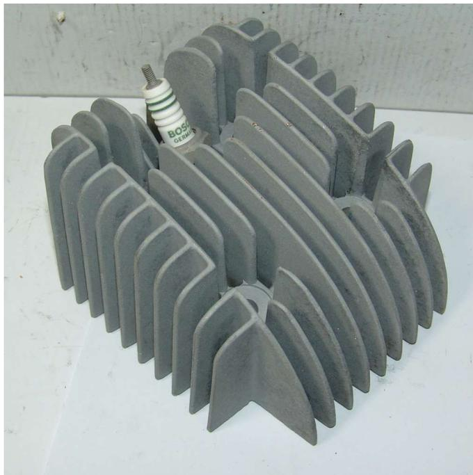
TESTATA CICLOMOTORE HEAD MOPED PARILLA 125 2 TEMPI (V4)
