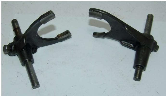
FORCHETTE SELETTORE CAMBIO FORKS SWITCH GEAR MV
