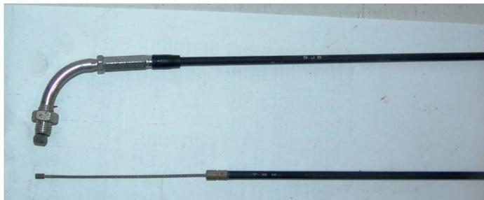
CAVO COMANDO GAS ACCELERATORE THROTTLE CABLE
