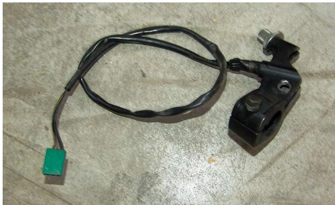
SUPPORTO LEVA FRENO SUPPORT FRONT BRAKE MOTO
