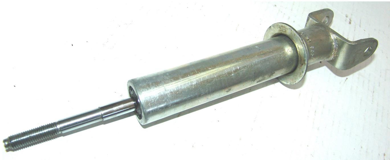
AMMORTIZZATORE POSTERIORE REAR SHOCK ABSORBER SEBAC 5953 040 PIAGGIO VESPA PK (V3X)
