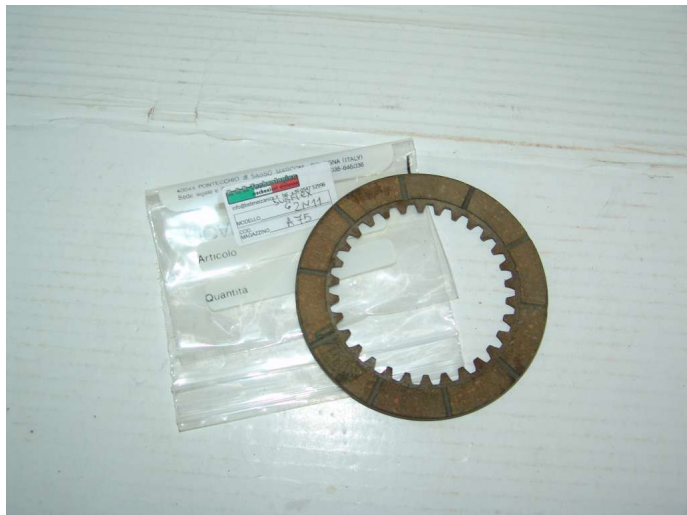
DISCO ACCIAIO FRIZIONE 1PZ 62M11 MORINI 175 4T TRESETTE
