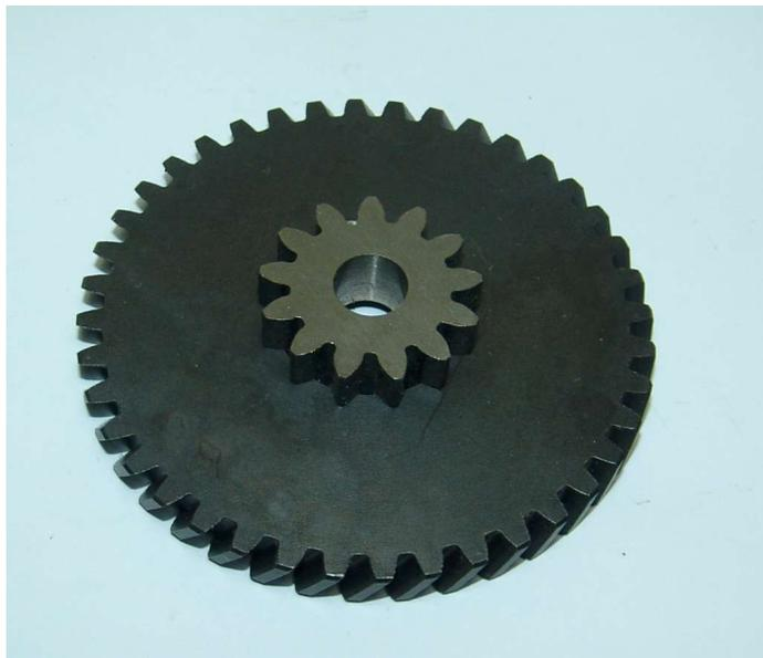
INGRANAGGIO PRIMARIA MOTORE CICLOMOTORE GARELLI
