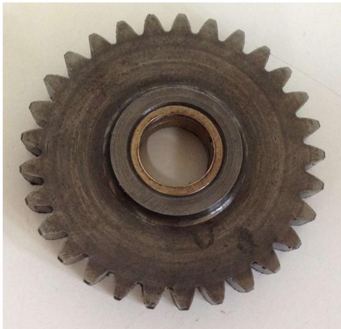
INGRANAGGIO MOTORE AVVIAMENTO CICLOMOTORE GARELLI
