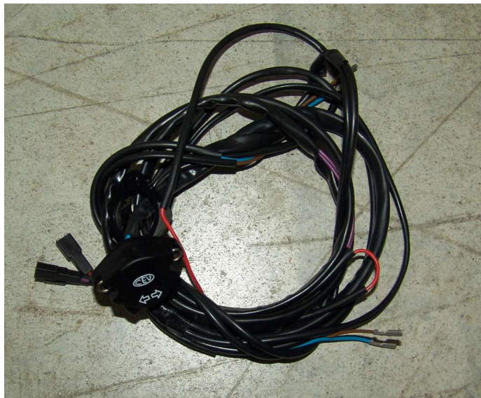
INTERRURE DEVIOFRECCHE CEV CON CABLAGGIO MALAGUTI
