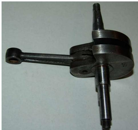
ALBERO MOTORE MOTOR SHAFT MOTORE MINARELLI M35 GARELLI AGRATI 48
