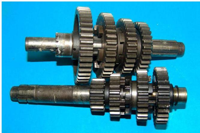
CAMBIO MOTORE CHANGE MOTOR DUCATI MONOCILINDRICO 4
