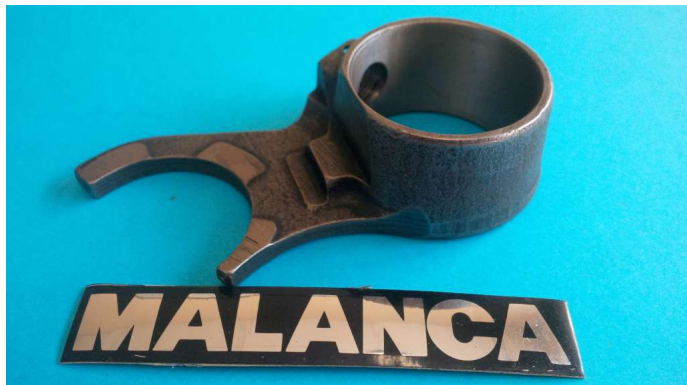
FORCHETTA SELETTORE CAMBIO CHANGE SELECTOR
