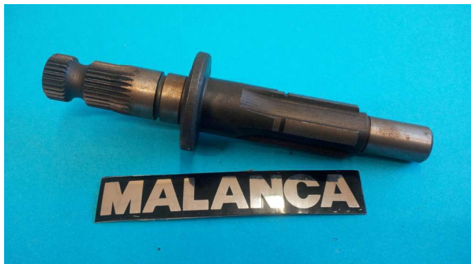
ALBERO MESSA IN MOTO MOTORE NUOVO PER MALANCA 125
