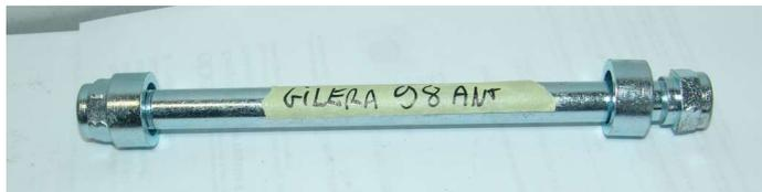
PERNO RUOTA ANTERIORE FRONT AXLE GILERA 98
