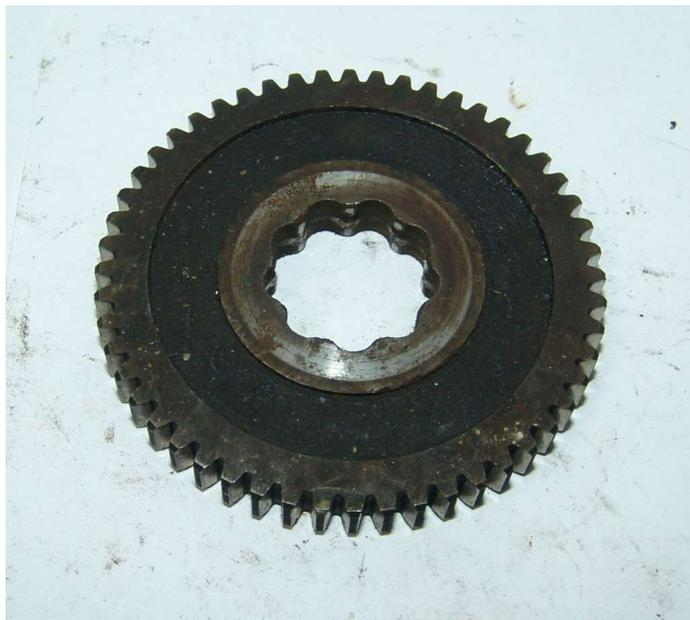
GEARSHIFT INGRANAGGIO CAMBIO PER MOTOM 48 (A355)
