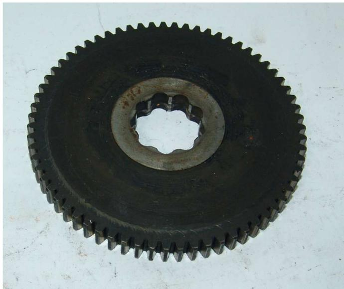
GEARSHIFT INGRANAGGIO CAMBIO PER MOTOM 48 (A358)
