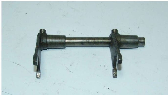
ALBERO SELETTORE CAMBIO FORKS SWITCH GEAR MV AGUSTA
