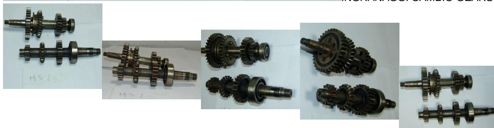
INGRANAGGI CAMBIO GEARS BENELLI LETIZIA 3 MARCE (MS2)
