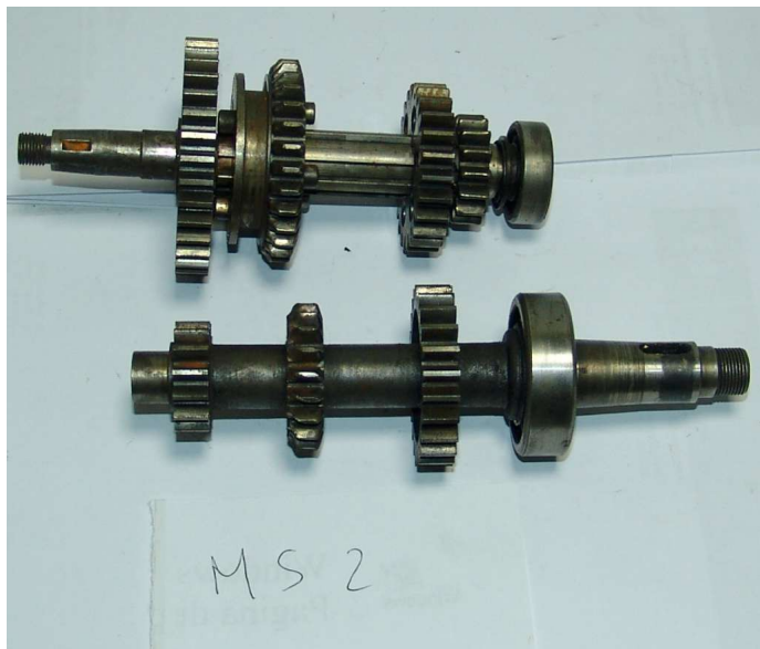
INGRANAGGI CAMBIO GEARS BENELLI LETIZIA 3 MARCE (MS2)
