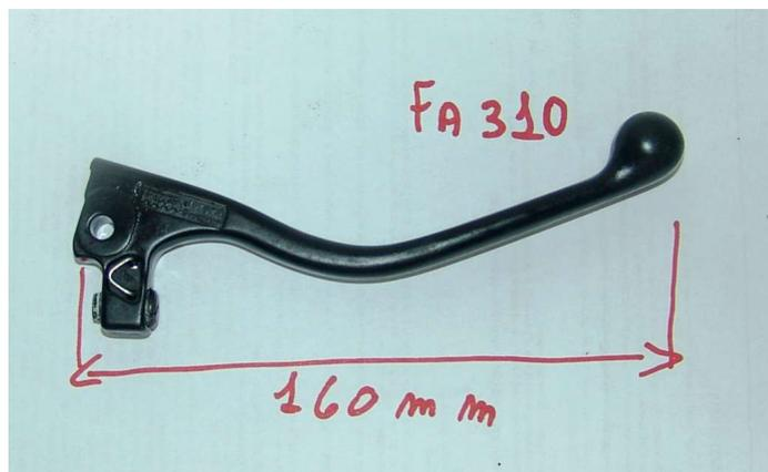
LEVA POMPA FRENO BRAKE PUMP LEVER FANTIC MOTOR FA310
