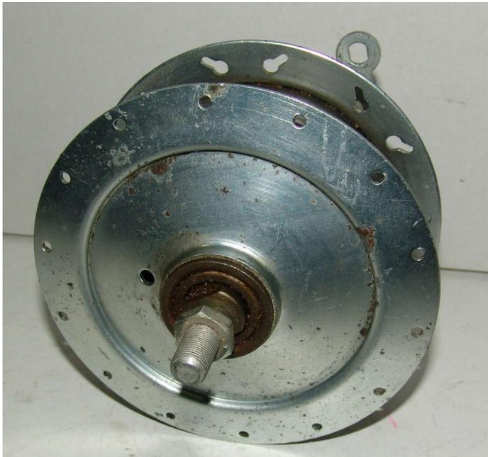
MOZZO RUOTA ANTERIORE FRONT WHEEL HUB CICLOMOTORE
