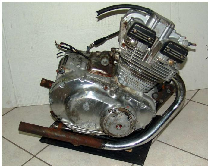
BLOCCO MOTORE ENGINE BLOCK SUZUKI BICILINDRICO TIPO
