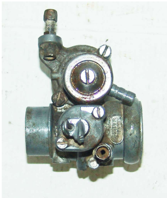
CARBURATORE CARBURATOR DELL ORTO MA18BS7 INNOCENTI
