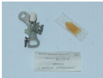
CONTATTI PUNTINE CONTACTS PINS MOTORCRAFT 682F-12107-AA FORD CAPRI 2000 GT & 3000
