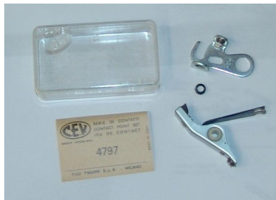
CONTATTI PUNTINE CONTACTS PINS CEV 4797 F.LLI PAGANI VESPA PIAGGIO 150 GS
